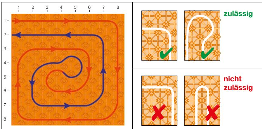
**10.** Beim Einbringen der systemzugehörigen Heizrohre mit Ø 10 mm sind diese in doppeltem Verlegeabstand bis zur Wendeschleife zu verlegen. Nach der Wende wird der Rücklauf (blaue Darstellung) im verbliebenen Freiraum mittig eingelegt. **Wichtig:** Umlenkung der Heizrohre gemäß Darstellung! Die Heizkreislänge beträgt max. 50 m.
