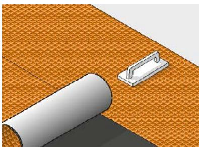
**15.** Für keramische Beläge/Naturstein: Verlegung der Verbundentkopplungsplatte Schlüter-DITRA in frischem Dünnbettmörtel nach Begehbarkeit des Estrichs. Bei Calciumsulfatestrich nach einer Restfeuchte von ≤ 2%.
