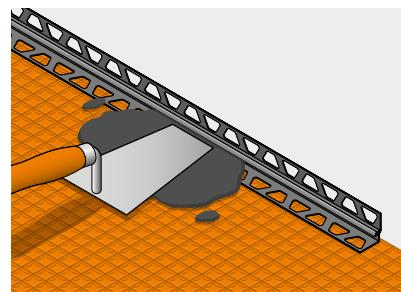
**17.** Einbau des Randbewegungsfugenprofils Schlüter-DILEX-EK bzw. -DILEX-RF.
